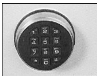
Serrure à clavier électronique. 1 million de combinaisons à 6 chiffres. Alimentation par 2 piles 9 v permettant 2 ans d'utilisation à raison de 10 ouvertures par jour. Le changement des piles n'entraîne pas la perte de la combinaison. Système de blocage en cas d'erreur.
